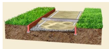
Pregătirea stratului suport pentru montarea pavajului
