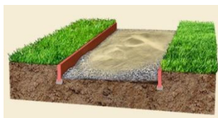
Pregătirea stratului suport pentru montarea pavajului
